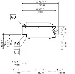
Electrical inlet (power) Equipotential screw
